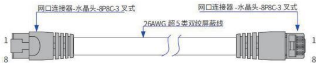
图 5-9 EtherCAT 网线制作要求
